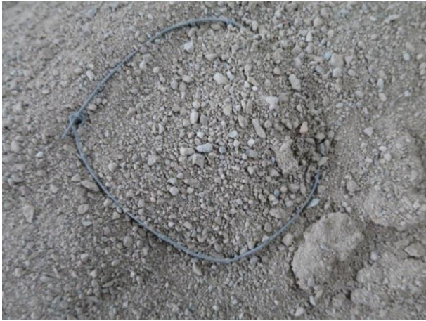
Figur 18. En nätkorg i form av en cylider placerades vertikalt från toppen till botten i högen .
