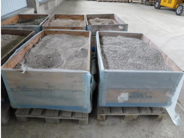
Figur 17. Högar med tre fraktioner (0/4, 4/8 och 8/16 mm) av vardera krossad slipper och håldäcksbetong. Botten av pallkragarna bestod av ett luftgenomsläppligt nät.
