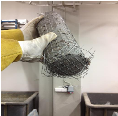
Figur 19. Provuttaget i nätkorgen. Prover för karbonatiseringsanalys togs sedan ut på 4 nivåer.
